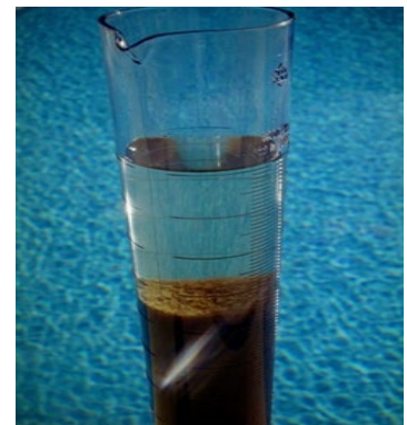
Abbildung 4: Messung Schlammvolumen, bzw. abgesetzte Belebtschlammflocken in einer Mensur (1000ml) (Quelle: Gallé Abwassertechnik)
