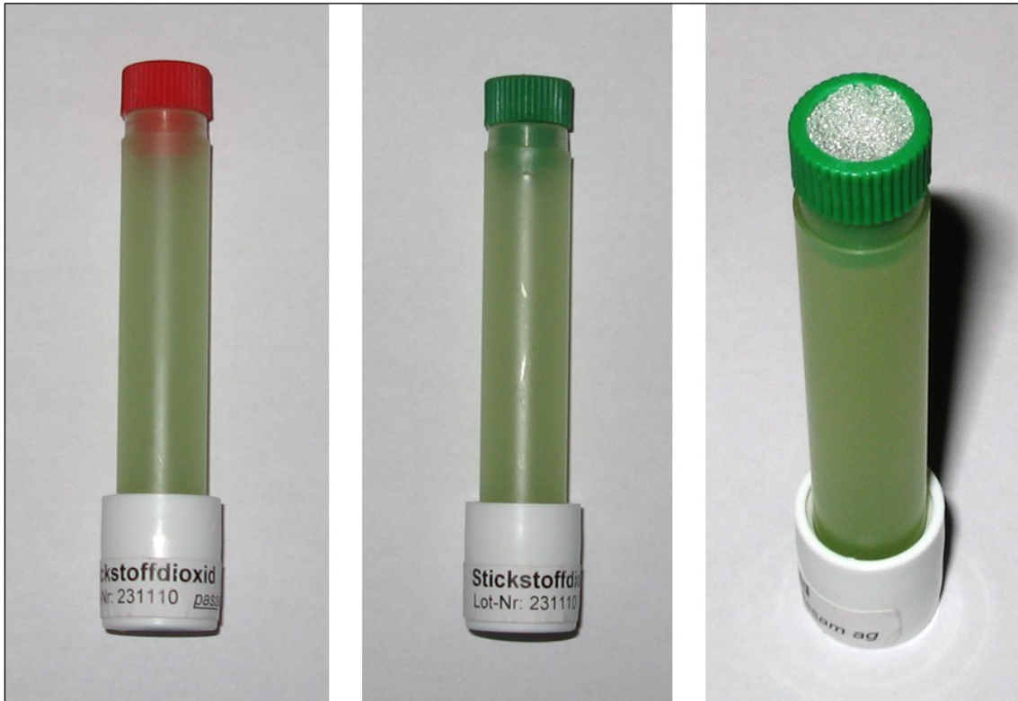
Abbildung 2: Passivsammler Transport (linkes Bild), Passivsammler Exposition (mittleres Bild), Turbulenzsperre des Passivsammlers (rechtes Bild)
