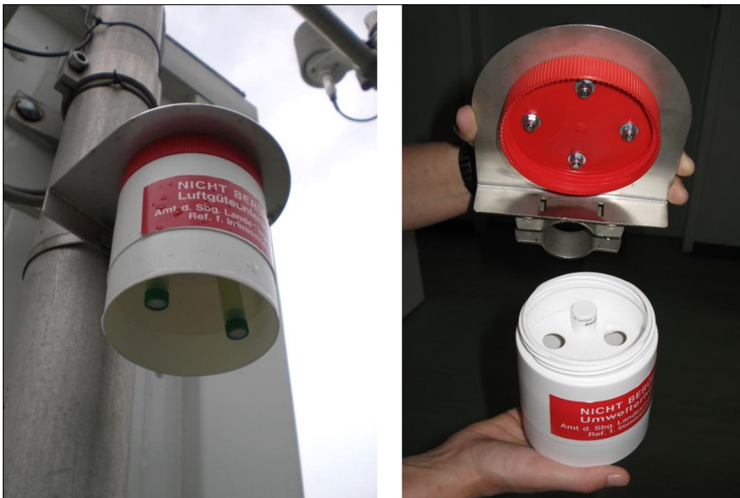
Abbildung 1: Schutzgehäuse eines Passivsammlers
