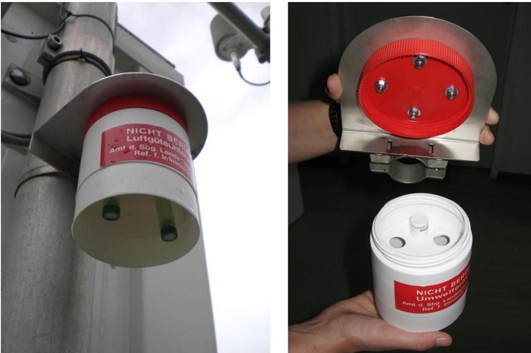
Abbildung 1: Schutzgehäuse eines Passivsammlers
