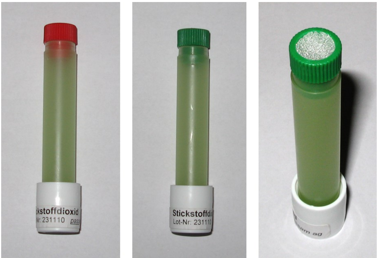
Abbildung 2: Passivsammler Transport (linkes Bild), Passivsammler Exposition (mittleres Bild), Turbulenzsperre des Passivsammlers (rechtes Bild)
