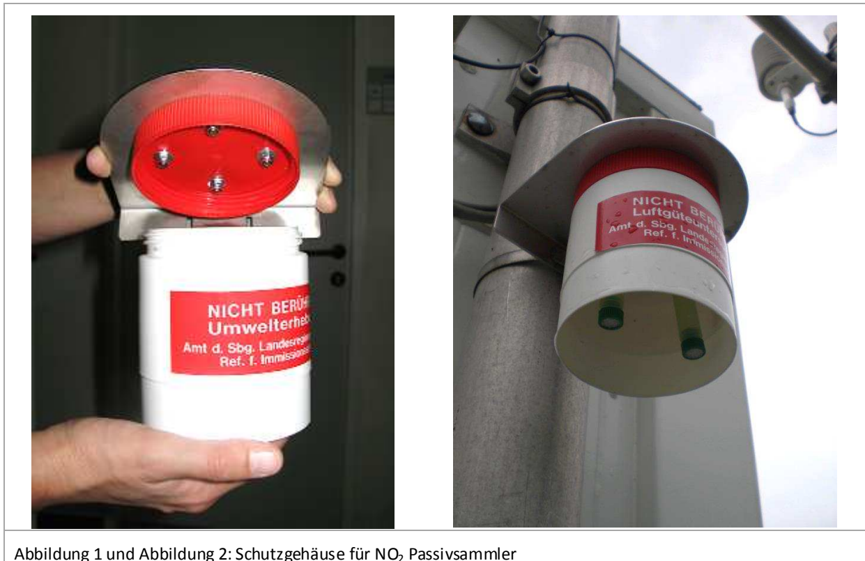
Abbildung 1 und Abbildung 2: Schutzgehäuse für NO 2 Passivsammler
