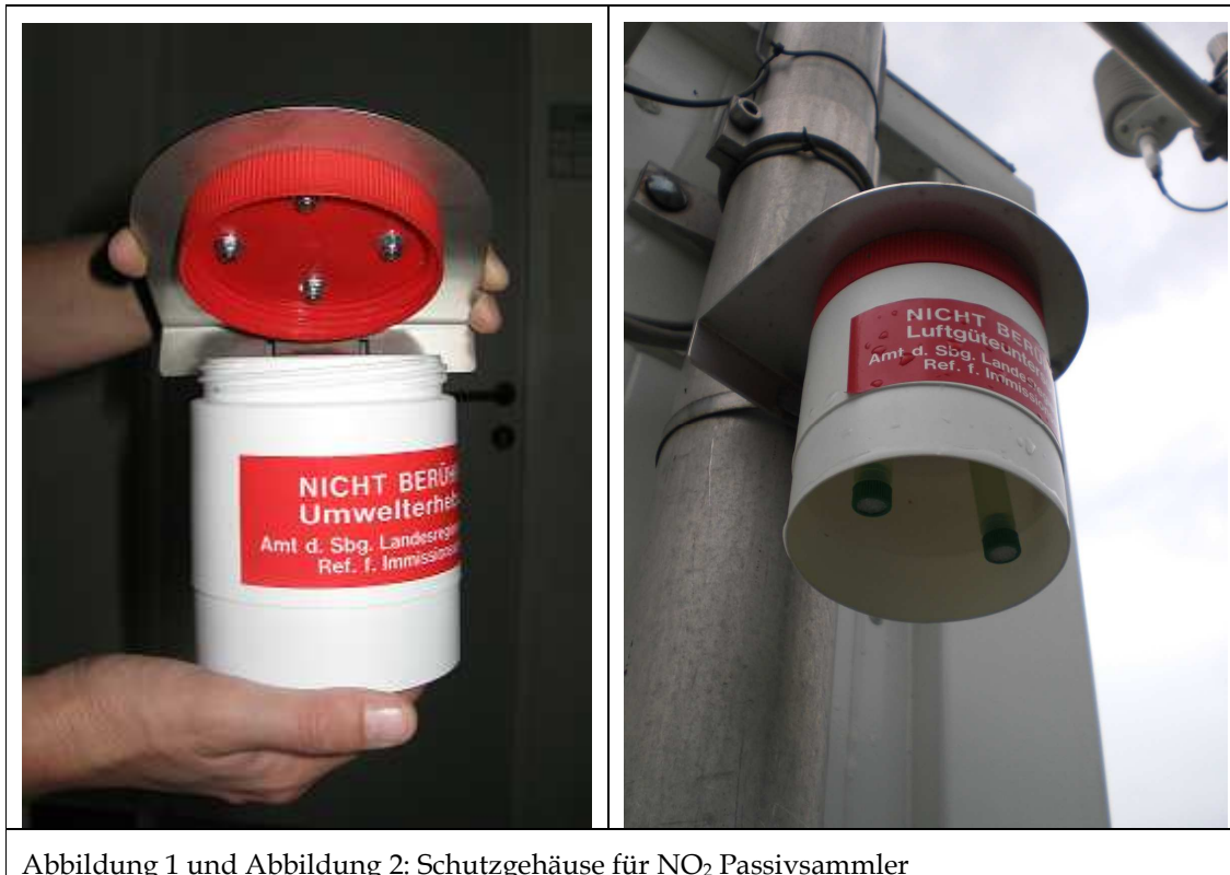
Abbildung 1 und Abbildung 2: Schutzgehäuse für NO 2 Passivsammler
