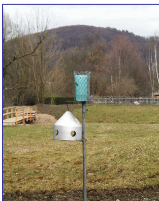
Abbildung 12: Bergerhoff-Messbecher und Passivsammler
