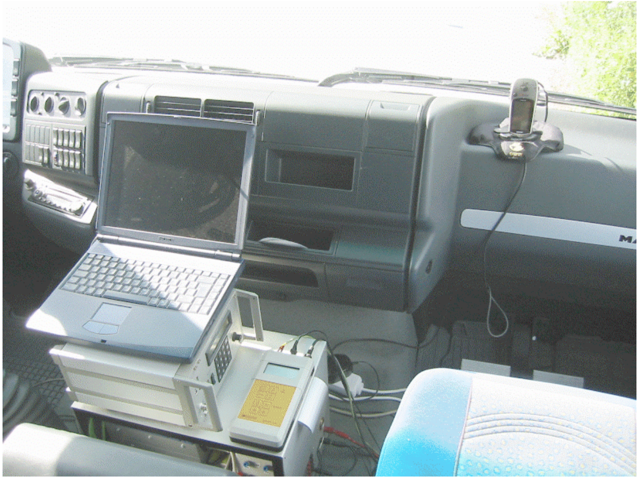
Abbildung 2: GPS-Einheit im Messwagen zur Erfassung der absoluten Höhe der Autobahnen im Untersuchungsgebiet.
