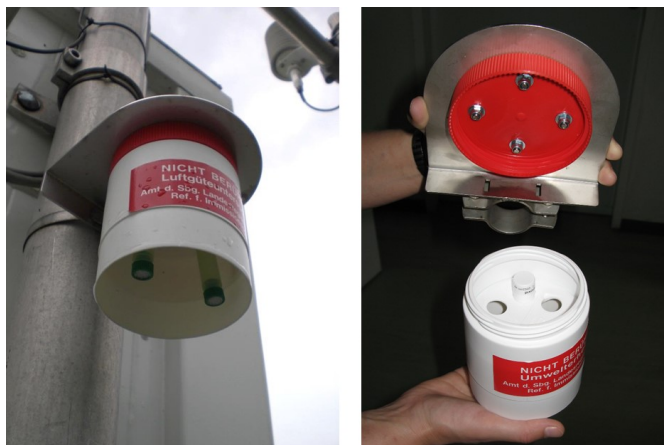
Abbildung 1: Schutzgehäuse eines Passivsammlers
