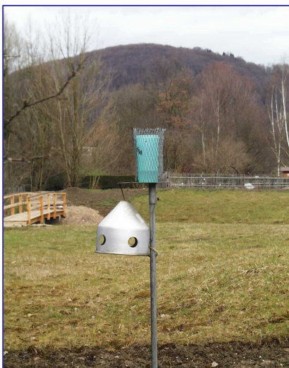
Abbildung 7: Bergerhoff-Messbecher und Passivsammler
