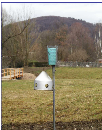
Abbildung 8: Bergerhoff-Messbecher und Passivsammler
