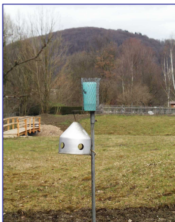
Abbildung 16: Bergerhoff-Messbecher und Passivsammler
