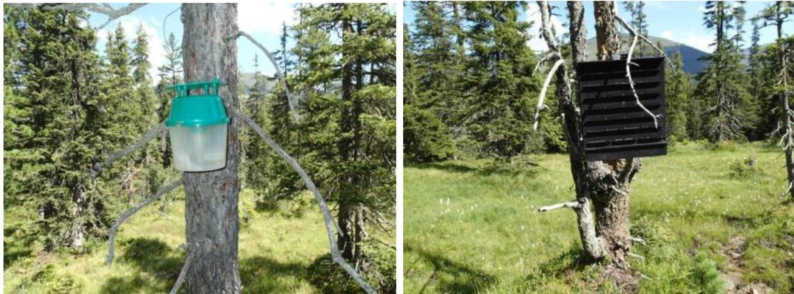
Abbildung 3-2: Verwendete Fallentypen: Variotrap (links) und Borkenkäfer-Schlitzfallen (rechts)
