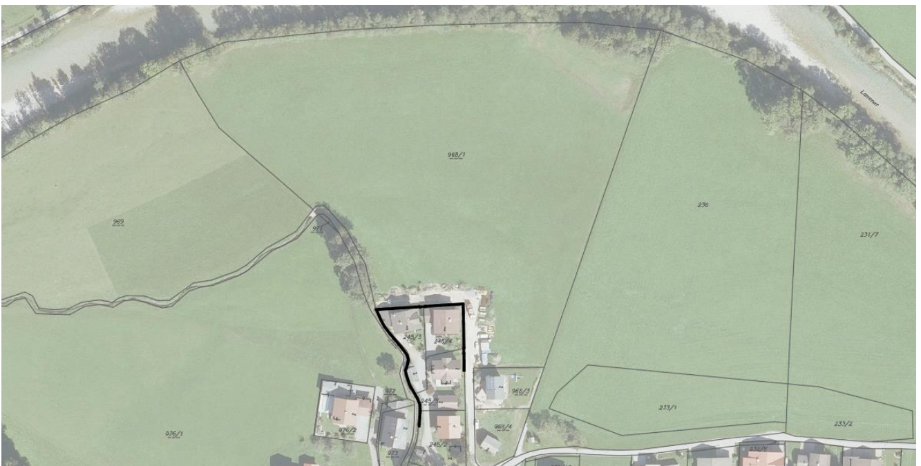
Abbildung 8: Lage der neu errichteten Hochwasserschutzmauer der im Bereich Bernhof (schwarz), ohne Maßstab
