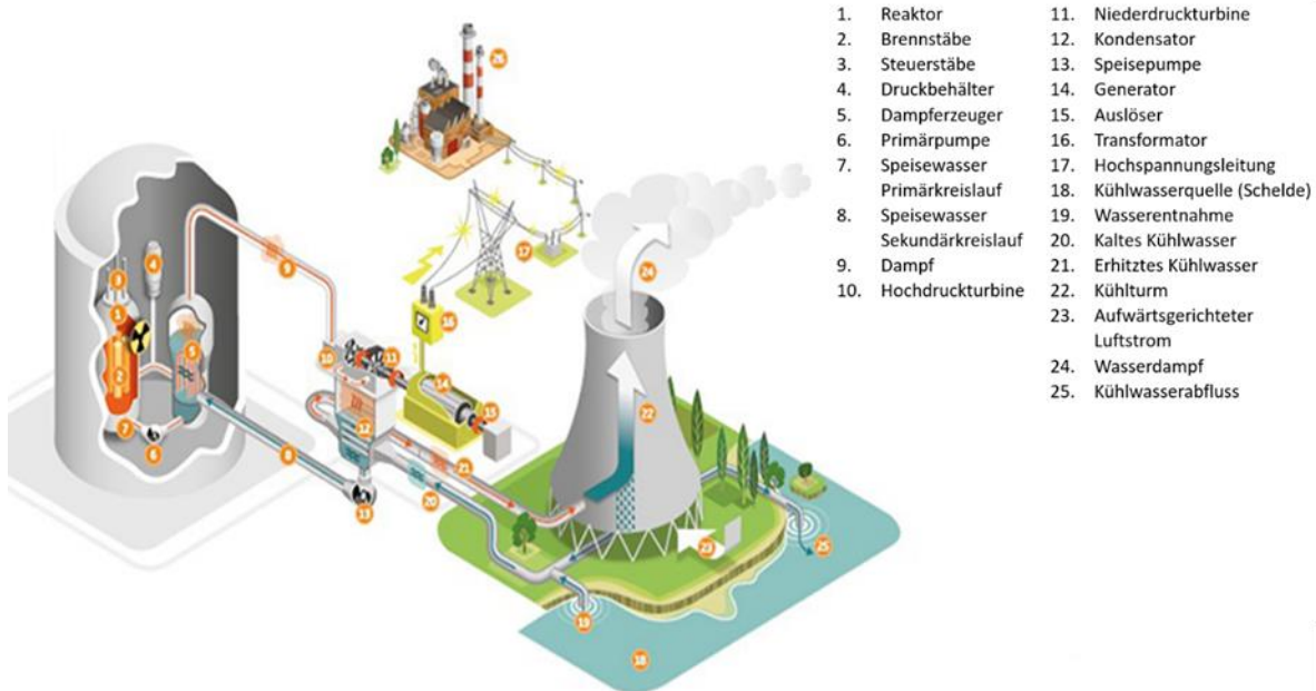
Abbildung 2: Betrieb eines Kernkraftwerks mit (von links nach rechts) dem Reaktorgebäude, dem Maschinenraum und dem Kühlkreislauf (Quelle: Electrabel AG).
