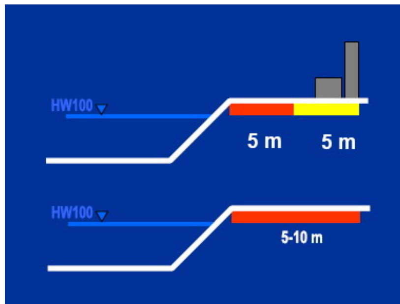
Abb. 5: Uferbegleitsstreifen in Abhängigkeit der angrenzenden Verbauung.
