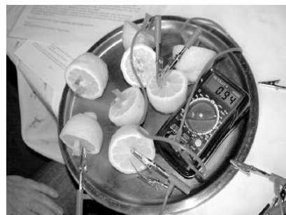
Lebensmittel nicht nur als Energiespender für uns Menschen – wie mit Hilfe von Zitronen Elektrizität erzeugt werden kann
