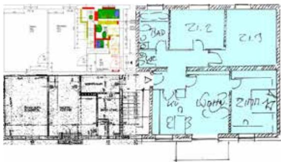
Möglichkeiten der Grundrissadaptierung
