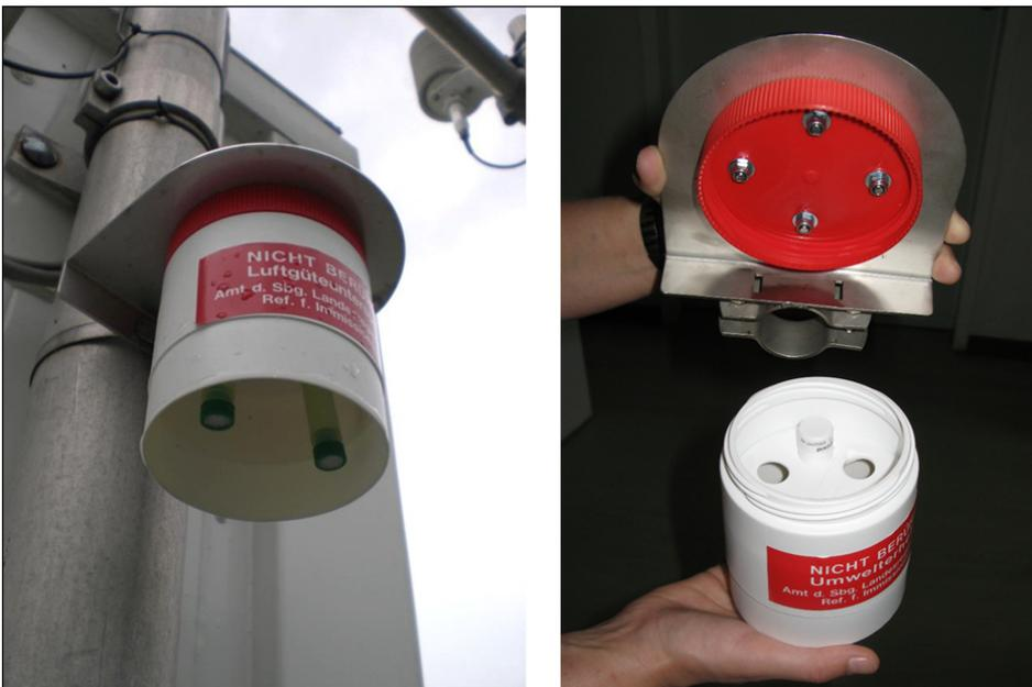
Abbildung 1: Schutzgehäuse eines Passivsammlers
