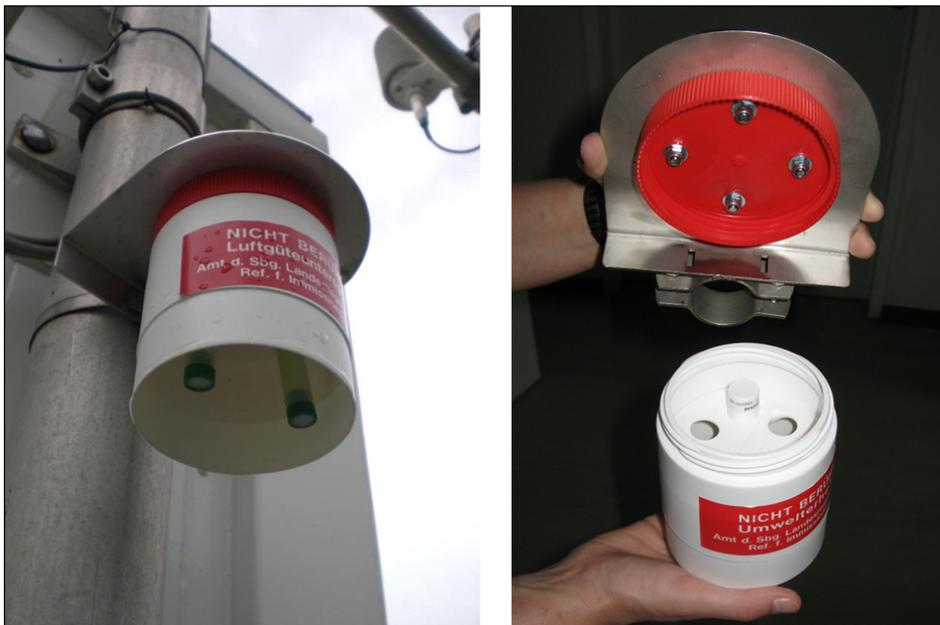
Abbildung 1: Schutzgehäuse eines Passivsammlers
