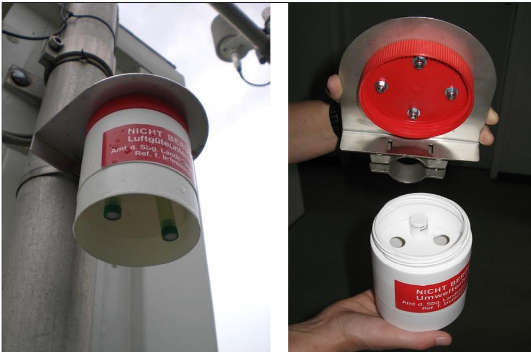
Abbildung 1: Schutzgehäuse eines Passivsammlers
