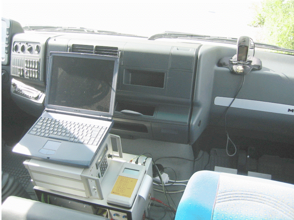
Abbildung 3: GPS-Einheit im Messwagen zur Erfassung der absoluten Höhe der Autobahnen im Untersuchungsgebiet.
