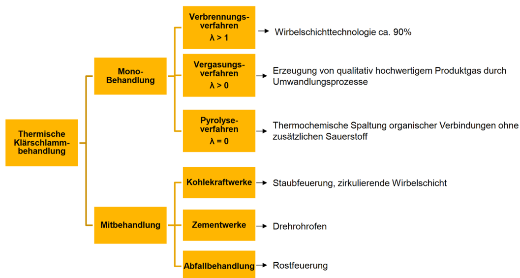
Abbildung 3: Thermische Klärschlammbehandlung - Verfahrensüberblick ((Franck, 2018) S. 9)
