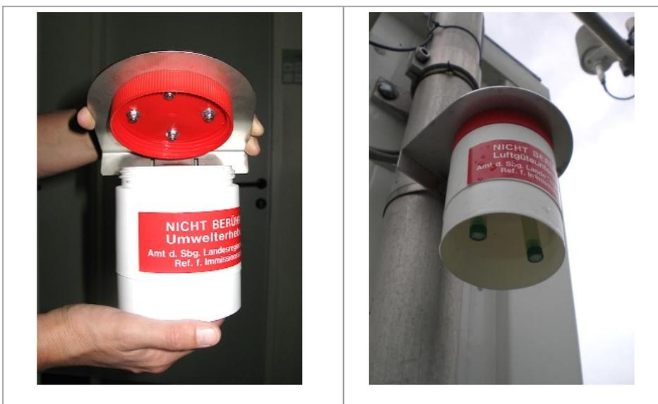
Abbildung 2: Schutzgehäuse für NO<sub>2</sub>-Passivsammler
