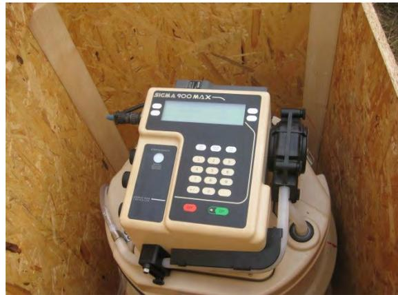
Abb. 13: Sampler mit aufgesetztem Oberteil
