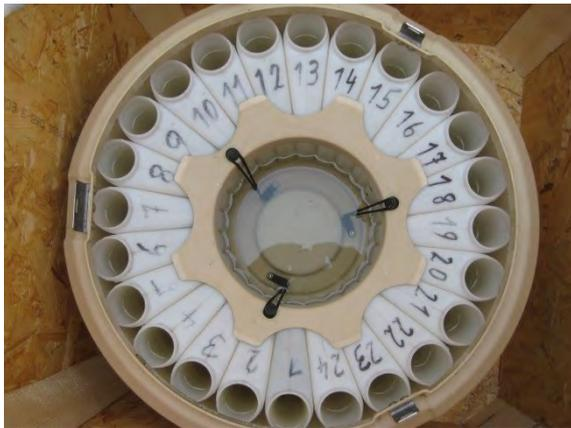
Abb. 12: Sampler-Unterteil mit 24 PE-Flaschen (1000 ml)
