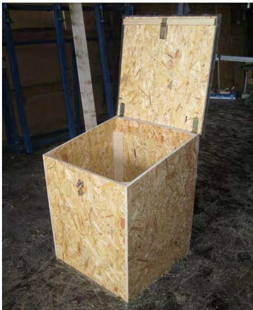
Abb. 14: Einhausung Sampler
