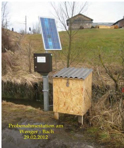
Abb. 16: Pegelmessstation und Probenahmestation am Wengerbach
