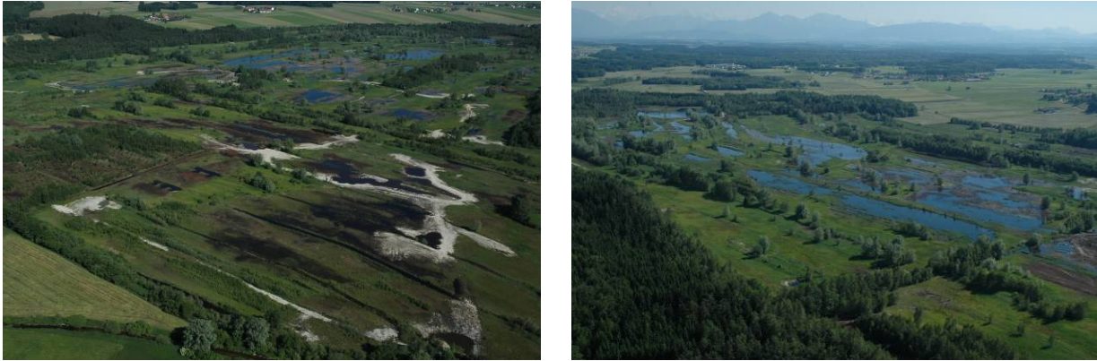
Abbildung 1-3: Blick auf den Maßnahmenbereich 2005 im Nordwesten des Weidmooses. Die in der Bauphase 2005 errichteten Dämme sind durch die helle Farbe des Tons gut erkennbar. Im Zentrum des Vogelschutzgebietes (rechts) entstehen die größten Wasserflächen. Hier ist das Stauziel noch nicht ganz erreicht (Schrägluftaufnahmen © Leininger Juni 2006).
