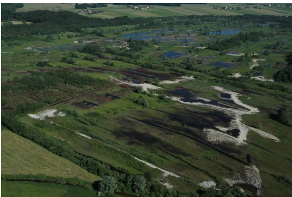
Abb. 48: Blick auf den Maßnahmenbereich 2005 im Nordwesten des Weidmooses. Die in der Bauphase 2005 errichteten Dämme sind durch die helle Farbe des Tons gut erkennbar. (Schrägluftaufnahmen © Leininger Juni 2006)
