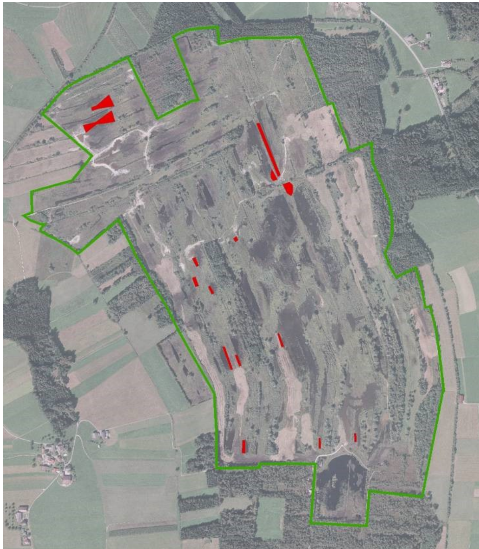
Abb. 13: 2006 wurde auf einer Fläche von 1,2 ha die Bodenverwendung (rot) mit Moorraupe und Traktor durchgeführt; grün: Grenze Vogelschutzgebiet
