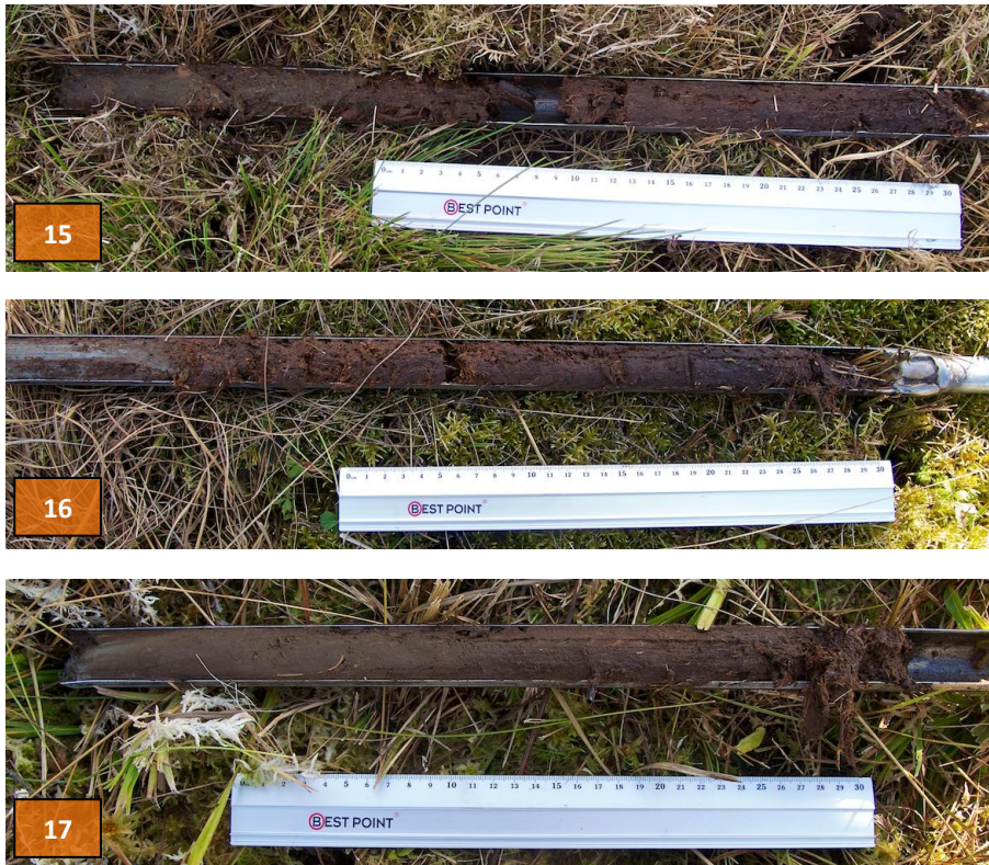
Abb. 28: Übersicht über die 17 exemplarisch gewonnenen Bodenprofile. (Das Lineal ist 30 cm lang).
