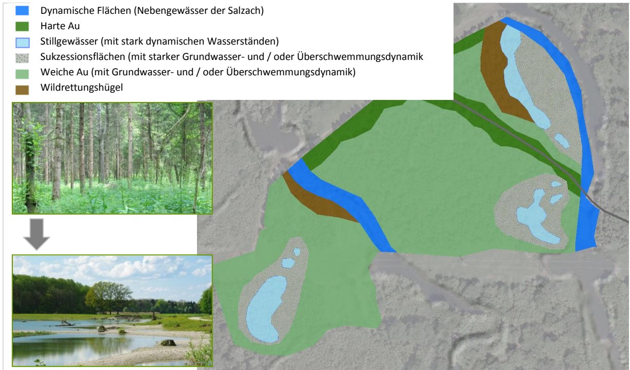
Abbildung 8-1: Prinzipalskizze Vorlandabsenkung mit Darstellung des Ausgangs- und Zielzustands (links)
