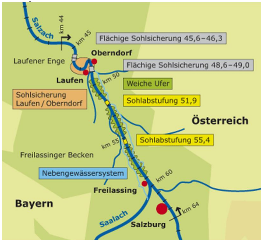
Abbildung 3-5: Maßnahmen aus dem Projekt Sanierung Untere Salzach
