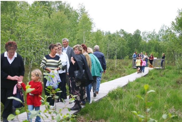
**Abb. 34** Der neue Themenweg im Weidmoos, hier der als Holz-Bohlenweg ausgeführte Abschnitt im Hochmoor mit hoher Lenkungsfunktion und geringem baulichen Eingriff; der wertvollste Hochmoorbereich wird vom Weg nicht berührt, ist aber einsehbar; gebietsangepasste individuelle Lösung: der Weg folgt der Trasse der alten Torfbahn, die Gleise wurden als Längslager wieder verwendet. (Foto: R. Nestlbacher)
