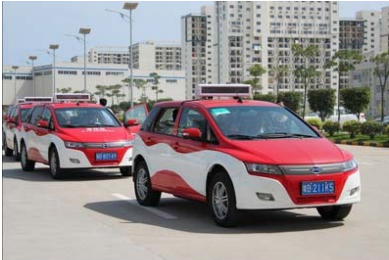
50 Taxi 1 Jahr Test, 54 Tausend km pro Taxi Schnitt, manche über 100 Tausen km 64 kWh Akku – 300 km Reichweite, 100 kW Schnellladung
