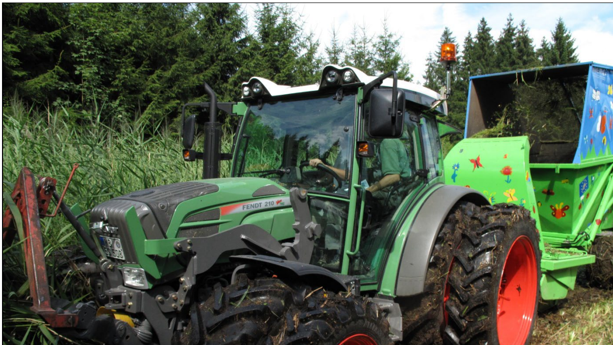
Der Mähcontainer des Landes Salzburg, gezogen von einem Schlepper mit Zwillingsbereifung, © C. Eichberger
