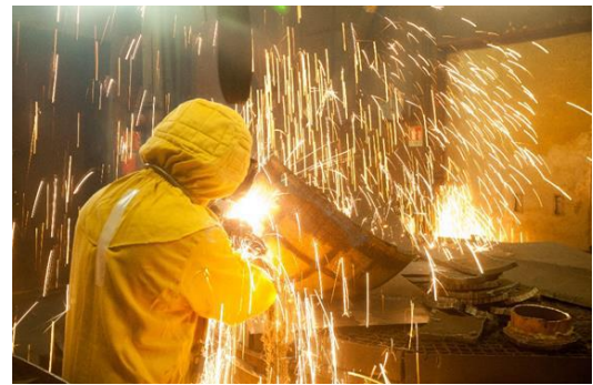
CENTRACO-Lebenszyklus – Trennen mit dem Schneidbrenner vor dem Einschmelzen
