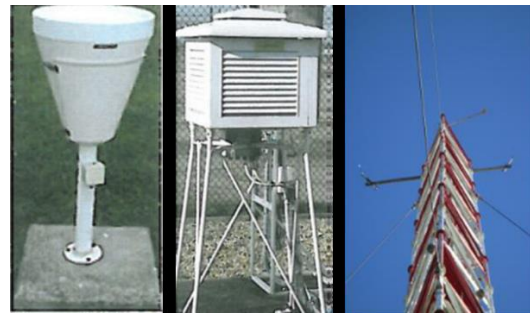
Beispiele von Gerätschaften zur Niederschlags-, Temperatur- und Windmessung ©EDF
