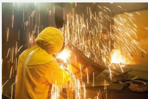
CENTRACO Cyclife – Thermisches Schneiden vor dem Schmelzen
