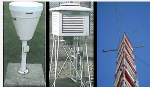
Beispiele für Geräte zur Messung von Niederschlag, Temperatur und Wind
