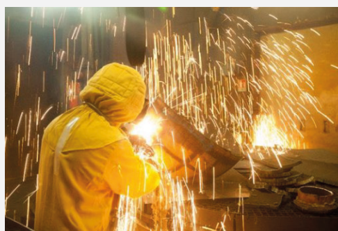
CENTRACO Cyclife - Découpe thermique avant fusion
