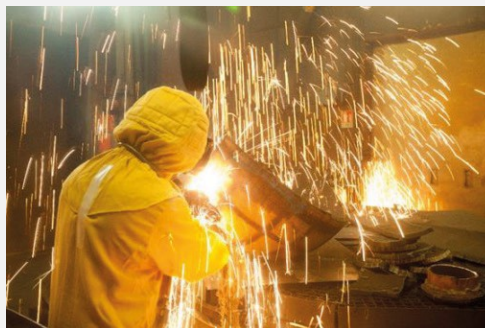
CENTRACO Cyclife – Thermisches Schneiden vor dem Schmelzen
