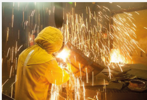
CENTRACO Cyclife - Découpe thermique avant fusion
