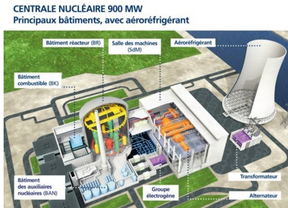
Abbildung 24. Lageplan der wichtigsten Gebäude eines Kernkraftwerks
