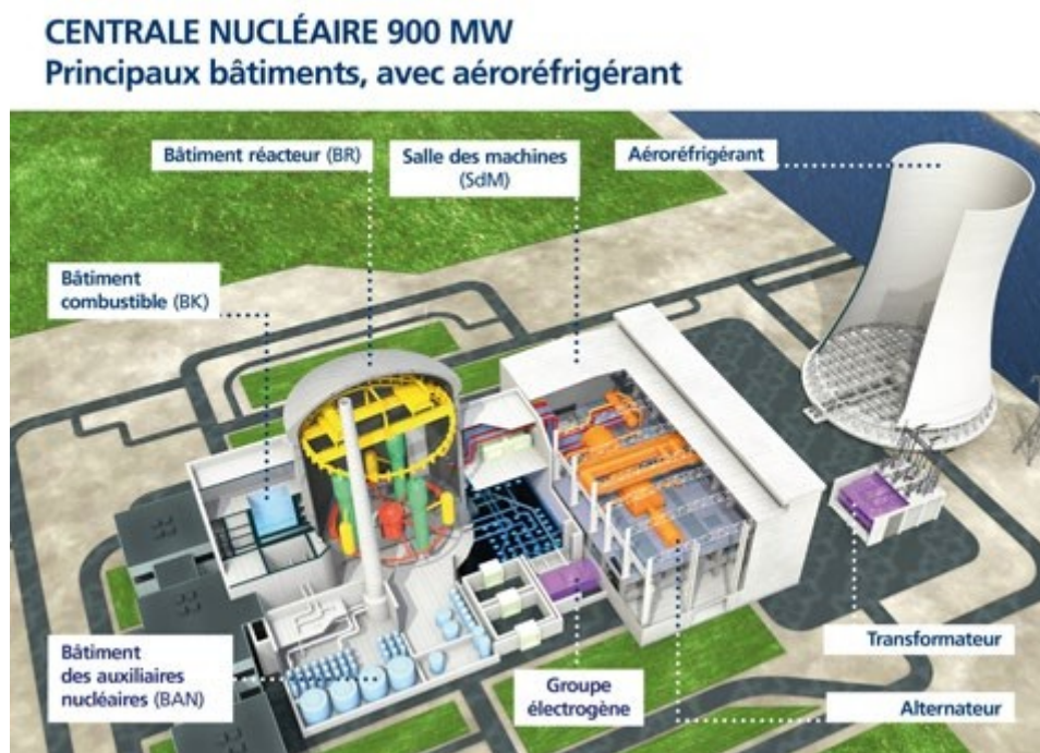
Abbildung 24. Lageplan der wichtigsten Gebäude eines Kernkraftwerks
