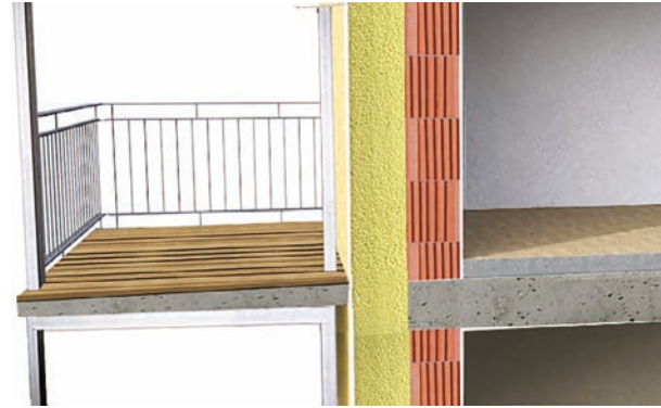
Vorgestellter Balkon - keine Wärmebrücke (FH Salzburg, Smart Building)
