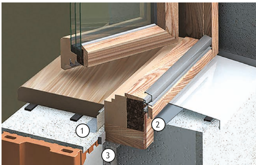
Dreiteiliger Baukörperanschluss/RAL Montage (FH Salzburg, Smart Building)
