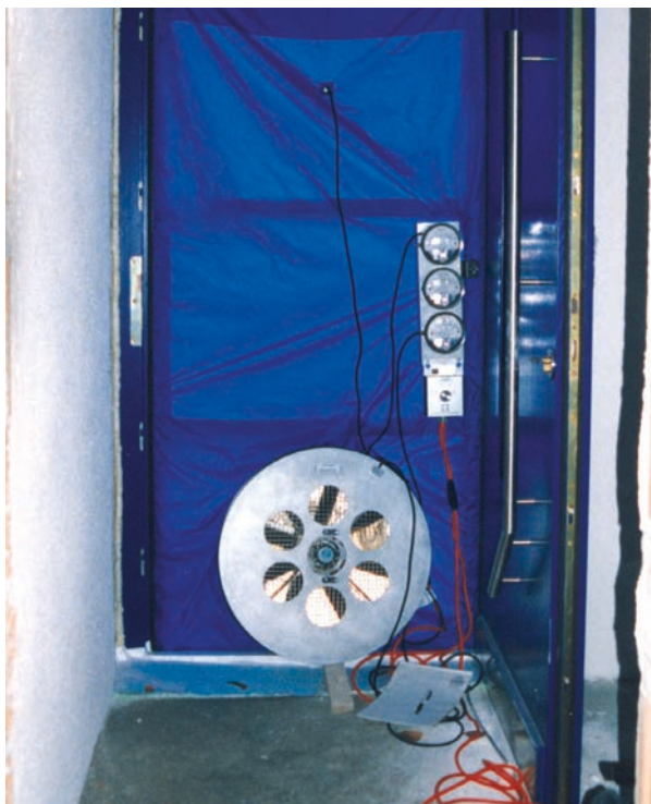
Blower Door Test (Holzbau Sohm)
