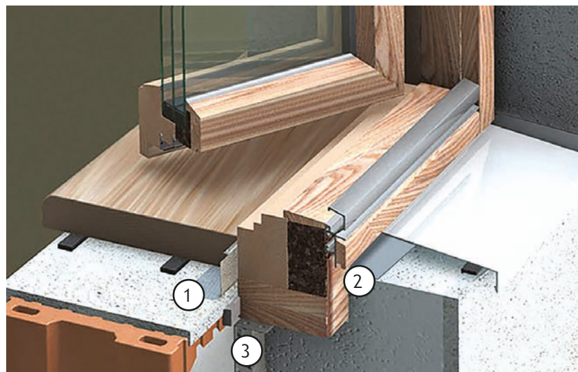
Dreiteiliger Baukörperanschluss/RAL Montage (FH Salzburg, Smart Building)
