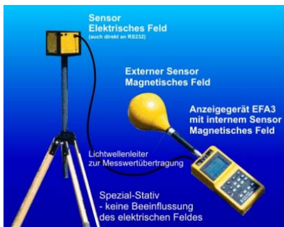
Abb. 2-1 : Dreiaxsiges Messsystem (EFA-3, Wandel&Goltermann) B-Feldmessung mit Kugelsonde, E-Feldmessung mit Würfelsonde, LWL-Verbindung zur Anzeige, Stativ
