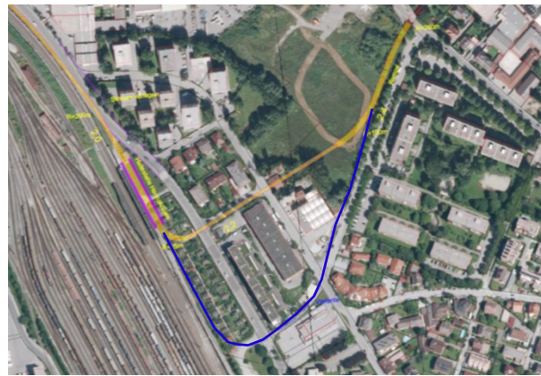
Abbildung 10: Variante der Stadtausfahrt im Bereich nach der Haltestelle Sam (blaue Linie), Quelle: [9]
