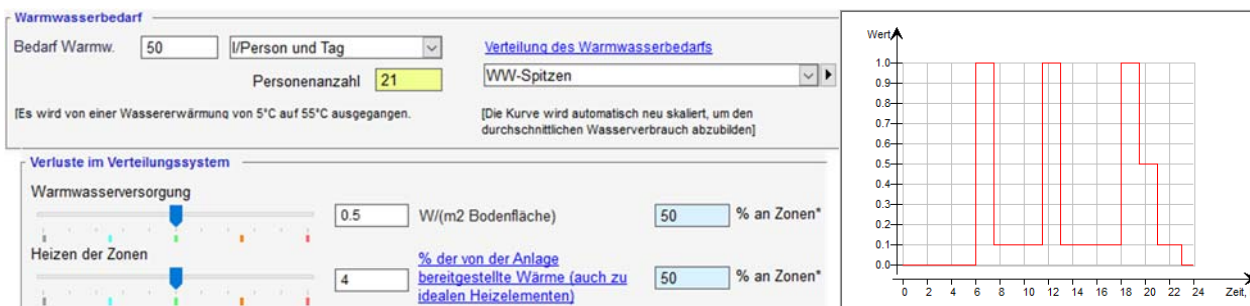
Abbildung 7: Randbedingungen für Warmwasserbedarf und Verteilungsplan Warmwasser (rechts)
