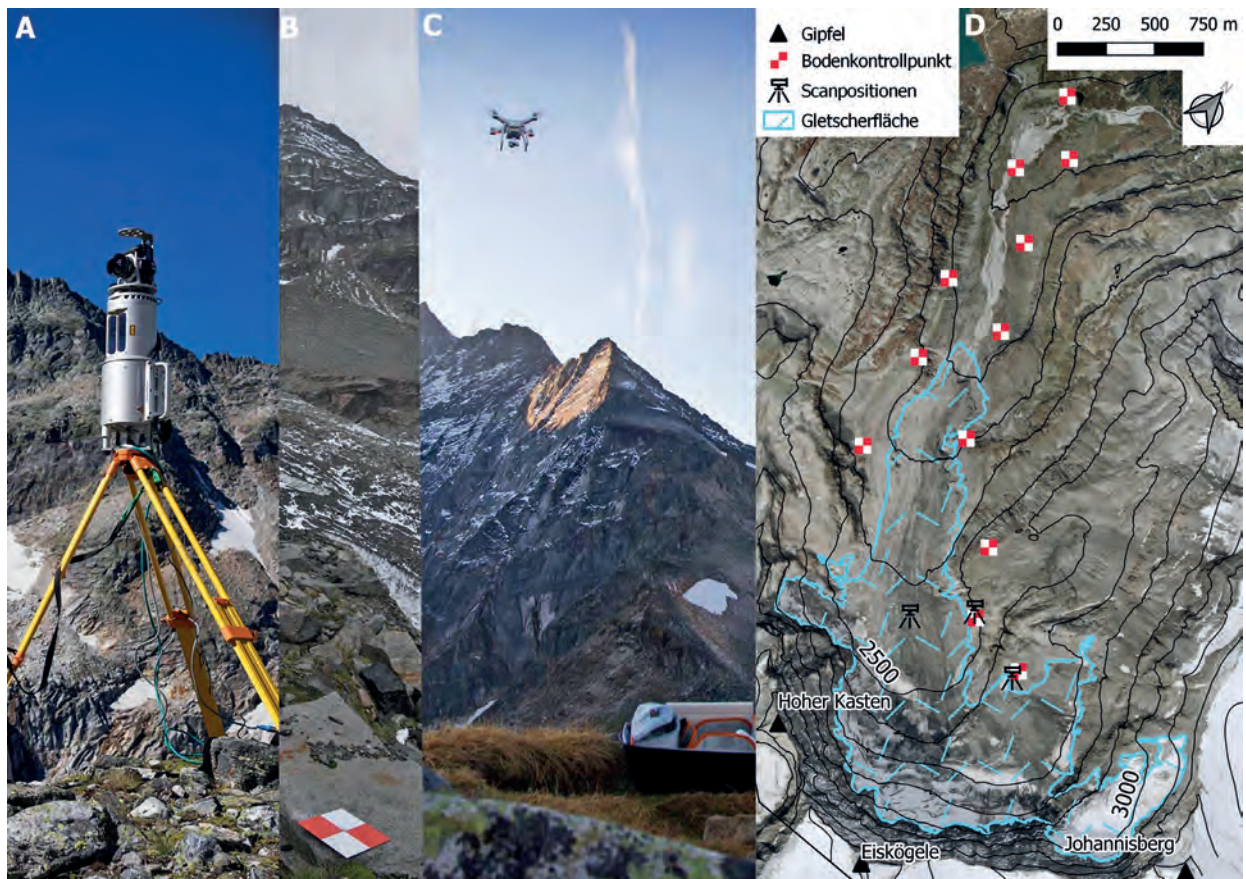
Figura 10: monitoraggio dei cambiamenti superficiali nell'area di studio Ödenwinkel. A: scansione laser terrestre, B: punto di controllo a terra per il volo UAS, C: volo UAS, D: cartina con posizioni di scansione e punti di controllo a terra, (fotografie: GEORESEARCH).
