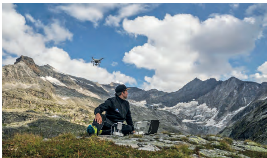
Figura 13: i due UAS (DJI Phantom4 Pro) all'inizio del volo in sciame.
