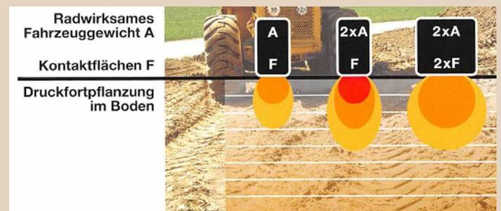
Die Druckfortpflanzung im Boden ist von der Bodenpressung (F) und vom Gesamtgewicht der Maschine (A) abhängig. [Quelle: FSK 2001]
