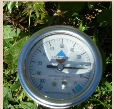
In den Boden eingebauter Tensiometer: Skala in hPa
